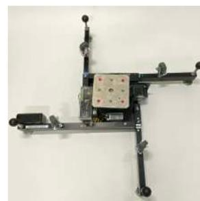
テーブルを乗せ、動力モーター部本体の赤い4つの点に合わせて、ネジ止めしてください。
